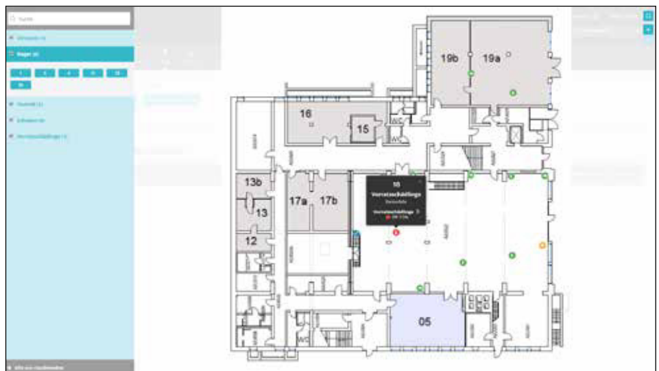
| Grundriss des Objekts mit eingezeichneten Monitoringstationen.
